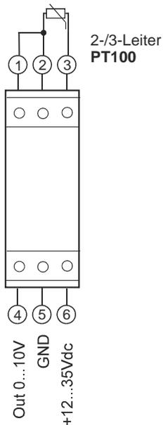
Die Ausgangsspannung folgt linear dem am Eingang anliegenden Temperatursignal. Zwischen dem Sensor und der Versorgungs- bzw. Ausgangsspannung darf keine galvanische Trennung bestehen.
