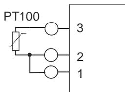
Bei der Zweileiterschaltung geht der Widerstand der Zuleitung in das Meßergebnis ein. Deshalb sollte diese Beschaltung nur bei kurzen Leitungslängen oder geringen Genauigkeitsanforderungen gewählt werden. Zwischen die Anschlüsse 1 und 2 muß am Meßumformer eine Brücke geklemmt werden.
